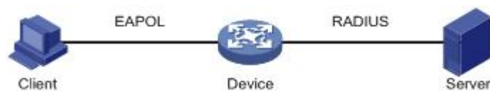
图 1-1 802.1X 认证系统的体系结构
