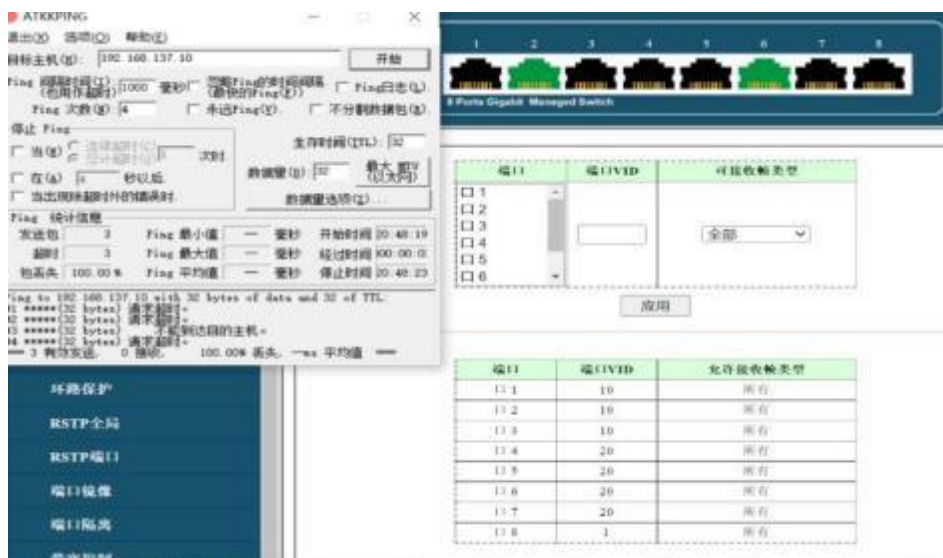
图 14 设置 VLAN 后端口 2/6 ping 不通 实现了端口 1、2、3 与端口 4、5、6、7 的隔离，与上联口 8 都能通信。
