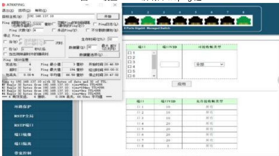
图 13 设置 VLAN 后端口 2/8ping 通
