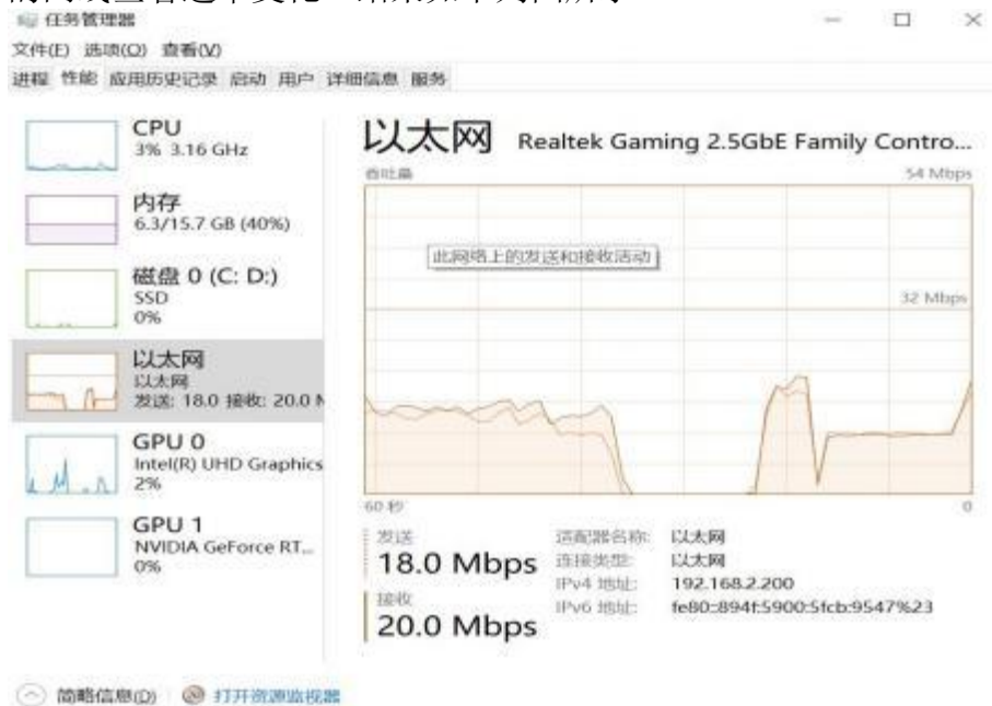
图 39 双网线连接时的速率
