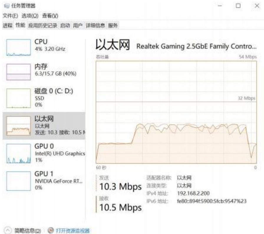
图 40 断开一条网线后的速率
